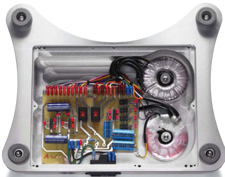
ÜBERSCHAUBAR: In den flach gehaltenen separaten Vorstufensockel passen nur wenige essentielle Netz-Bauteile, sprich Haupt- und Standby-Trafo, Gleichrichterdiode und Elkos.
